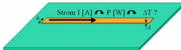
Abb. 3-4: Definition der Breite und Dicke der Leiterbahn auf der Leiterplatte
