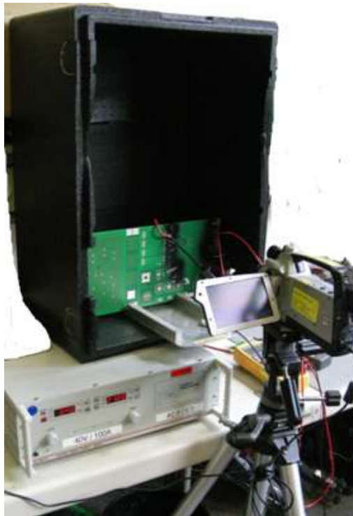
Bild 1 Beispiel für einen Messaufbau, um unerwünschte Nebeneffekte bei der Thermografie zu unterdrücken.
